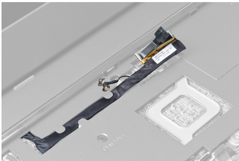
9. ถอดสกรูจากด้านหน้าคอมพิวเตอร์
